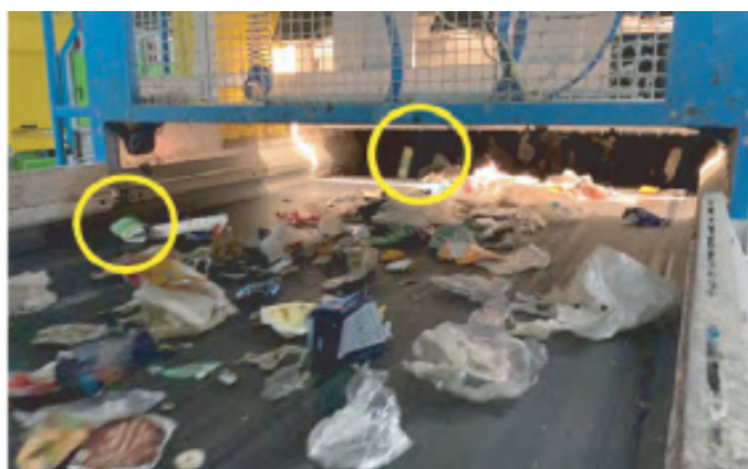
图片2：近红外分拣设备显示纸罐的分拣过程
